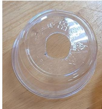
圖五、使用塑膠瓶,並設置 3-3.8mm 開口。
